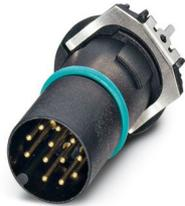
Portacontatti, 12-poli, Connettore, diritto, M12, codifica: A, Montaggio dei circuiti stampati, Attacco a saldare THR, Prodotto alternativo secondo RoHS II senza eccezione 6c (Pb < 0,1 %) cod. art.: 1239762
