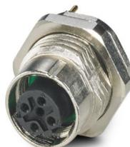
Connettore per apparecchi posteriore, 4-poli, Femmina, M12, codifica: D, Montaggio posteriore, M16 x 1,5, Saldatura a onde, Questo articolo è in continuo adattamento. Alternativa senza piombo secondo RoHS II senza eccezione 6c (Pb < 0,1%) possibile in anticipo su richiesta.
