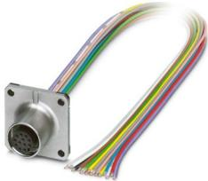
Connettore per apparecchi anteriore, 17-poli, Femmina, diritto, M12, codifica: A, su estremità conduttore libera, Montaggio anteriore/flangia quadrata, Fili singoli, lunghezza cavo: 0,5 m, 0,14 mm<sup>2</sup>, Filo in TPE, saldato, Questo articolo è in continuo adattamento. Alternativa senza piombo secondo RoHS II senza eccezione 6c (Pb < 0,1%) possibile in anticipo su richiesta.
