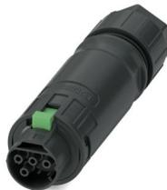
Connettore per giunti, Serie di prodotti: ArcZero, colore: nero, numero poli: 3, sezione del conduttore min.: 1,5 mm<sup>2</sup>, sezione del conduttore max.: 6 mm<sup>2</sup>, tensione di dimensionamento: 800 VDC, corrente nominale: 20 A, Tipo di connessione: Connessione a vite, Tipo di connessione del contatto: Femmina, diametro cavo min.: 8 mm, diametro cavo max.: 21 mm, Carico massimo alla disconnessione: 16 kW, campo di applicazione: DC-Grids
