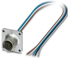
Connettore per apparecchi anteriore, 5-poli, Femmina, diritto, M12, codifica: A, su estremità conduttore libera, Montaggio anteriore/flangia quadrata, Fili singoli, lunghezza cavo: 0,5 m, 0,34 mm<sup>2</sup>, Filo in TPE, saldato, Questo articolo è in continuo adattamento. Alternativa senza piombo secondo RoHS II senza eccezione 6c (Pb < 0,1%) possibile in anticipo su richiesta.
