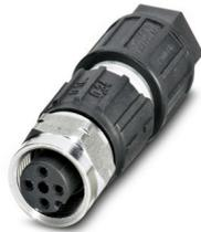
Connettore, Universale, 4-poli, Femmina diritto M12, codifica: A, Connessione a perforazione di isolante, materiale zigrinato: Acciaio legato 1.4404, diametro esterno conduttore 3,5 mm ... 6 mm
