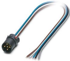
Portacontatti, 5-poli, Connettore, diritto, M12, codifica: B, su estremità conduttore libera, Montaggio anteriore/flangia quadrata, M12, Fili singoli, lunghezza cavo: 0,5 m, 0,34 mm<sup>2</sup>, Filo in TPE, Questo articolo è in continuo adattamento. Alternativa senza piombo secondo RoHS II senza eccezione 6c (Pb < 0,1%) possibile in anticipo su richiesta.
