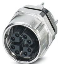
Connettore per apparecchi posteriore, 8-poli, Femmina, diritto, M12-SPEEDCON, codifica: X, Montaggio posteriore, Attacco a saldare THR, Questo articolo è in continuo adattamento. Alternativa senza piombo secondo RoHS II senza eccezione 6c (Pb < 0,1%) possibile in anticipo su richiesta.
