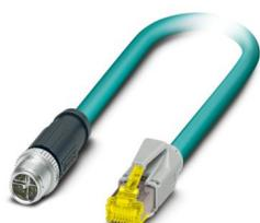
Cavo di rete, Ethernet CAT6<sub>A</sub> (10 Gbit/s), 8-poli, PUR senza alogenati, azzurro mare RAL 5021, Maschio diritto M12, codifica: X / IP65, su Maschio diritto RJ45 / IP20, lunghezza cavo: 15 m
