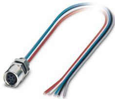
Connettore per apparecchi anteriore, DeviceNet™, 5-poli, Femmina, diritto, M8, codifica: B, Montaggio anteriore, M8 x 0,5, Fili singoli, lunghezza cavo: 0,5 m, 0,25 mm<sup>2</sup>, filo in PVC
