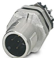
Connettore per apparecchi posteriore, 5-poli, Connettore, diritto, M12-SPEEDCON, codifica: A, Montaggio posteriore, M12 x 1, Attacco a saldare THR, Questo articolo è in continuo adattamento. Alternativa senza piombo secondo RoHS II senza eccezione 6c (Pb < 0,1%) possibile in anticipo su richiesta.
