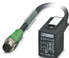
Cavo sensore/attuatore, 3-poli, PUR senza alogenati, grigio-nero RAL 7021, Maschio diretto M12, codifica: A, con 1 LED, su Connettore per valvole B (10 mm), con 1 LED, Circuito: Diodo Z, lunghezza cavo: 5 m
