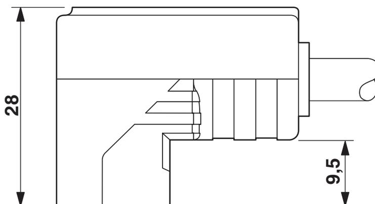
Connettore per valvole, formato C, vista laterale
