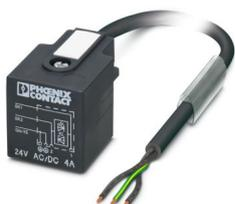
Cavo sensore/attuatore, 3-poli, PVC, nero RAL 9005, estremità conduttore libera, su Connettore per valvole A, con 1 LED , Circuito: Diodo Z, lunghezza cavo: 5 m
