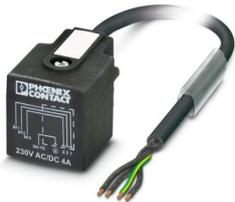
Cavo sensore/attuatore, 4-poli, PUR senza alogenati, grigio-nero RAL 7021, estremità conduttore libera, su Connettore per valvole AD (pressostato), Circuito: senza circuito, lunghezza cavo: 3 m
