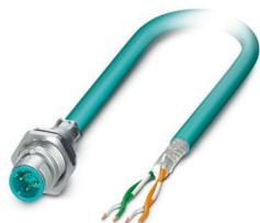
Connettore maschio da incasso sistema bus, Ethernet, 4 poli, M12 SPEEDCON, schermato, codifica D, montaggio posteriore/a vite, con filettatura Pg9, con cavo bus da 0,5 m, 2 x 2 x 0,2 mm<sup>2</sup>
