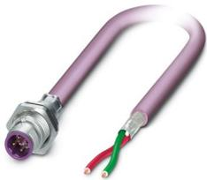
Connettore per apparecchi posteriore, PROFIBUS, 2-poli, PUR senza alogenati, lilla rossastro RAL 4001, schermata, Connettore, diritto, M12-SPEEDCON, codifica: B, su estremità conduttore libera, Montaggio posteriore, Collegamento del cavo, lunghezza cavo: 0,5 m, PROFIBUS, Prodotto alternativo secondo RoHS II senza eccezione 6c (Pb < 0,1 %) cod. art.: 1239654
