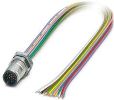
Connettore per apparecchi posteriore, Universale, 17-poli, Connettore, diritto, M12-SPEEDCON, codifica: A, su estremità conduttore libera, Montaggio posteriore, M12 x 1, Fili singoli, lunghezza cavo: 0,5 m, 0,14 mm<sup>2</sup>, Filo in TPE, saldato, Questo articolo è in continuo adattamento. Alternativa senza piombo secondo RoHS II senza eccezione 6c (Pb < 0,1%) possibile in anticipo su richiesta.
