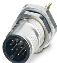
Connettore per apparecchi posteriore, 12-poli, Connettore, diritto, M12-SPEEDCON, codifica: A, Montaggio posteriore, M12 x 1, Codoli, Questo articolo è in continuo adattamento. Alternativa senza piombo secondo RoHS II senza eccezione 6c (Pb < 0,1%) possibile in anticipo su richiesta.
