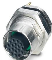
Connettore per apparecchi posteriore, 17-poli, Femmina, diritto, M12-SPEEDCON, codifica: A, Montaggio posteriore, Pg9, Codoli, Questo articolo è in continuo adattamento. Alternativa senza piombo secondo RoHS II senza eccezione 6c (Pb < 0,1%) possibile in anticipo su richiesta.
