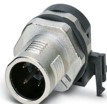
Connettore per apparecchi posteriore, 4-poli, Connettore, angolato, M12-SPEEDCON, codifica: A, Montaggio posteriore, M12 x 1, Codoli, Questo articolo è in continuo adattamento. Alternativa senza piombo secondo RoHS II senza eccezione 6c (Pb < 0,1%) possibile in anticipo su richiesta.
