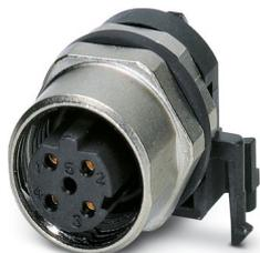
Connettore per apparecchi anteriore, 4-poli, Femmina, angolato, M12-SPEEDCON, codifica: D, Montaggio anteriore, M12 x 1, Codoli, Questo articolo è in continuo adattamento. Alternativa senza piombo secondo RoHS II senza eccezione 6c (Pb < 0,1%) possibile in anticipo su richiesta.
