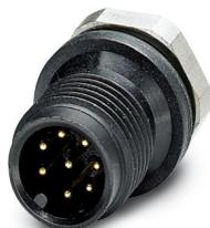
Connettore femmina da incasso sensore-attuatore, 8 poli, M12, codifica A, montaggio anteriore/a vite con filettatura M12, con connessione a saldare, variante in plastica
