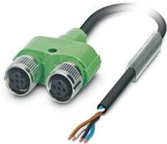
Cavo sensore/attuatore, 4-poli, PUR senza alogenati, grigio-nero RAL 7021, estremità conduttore libera, su Connettore femmina diritto M12 SPEEDCON, codifica: A e Connettore femmina diritto M12 SPEEDCON, codifica: A, lunghezza cavo: 10 m
