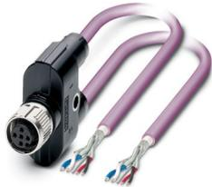
Cavo di sistema bus, CANopen®, DeviceNet™, 5-poli, PUR senza alogenati, lilla rossastro RAL 4001, schermata, Connettore femmina diritto M12 SPEEDCON, codifica: A, su estremità conduttore libera e estremità conduttore libera, lunghezza cavo: 2 m, Connettore non schermato, Schermatura collegata su Pin 1
