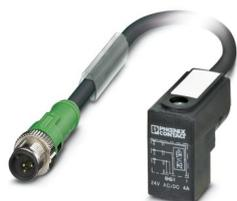
Cavo sensore/attuatore, 3-poli, PUR senza alogenati, grigio-nero RAL 7021, Maschio diritto M12 SPEEDCON, codifica: A, su Connettore per valvole C (8 mm), con 1 LED , Circuito: Diodo Z, lunghezza cavo: 0,3 m
