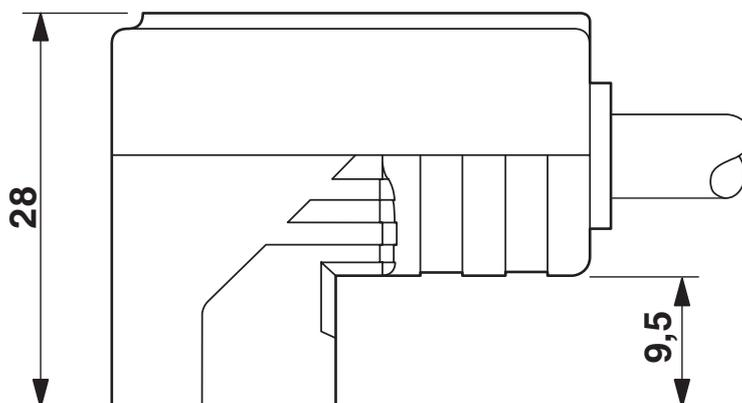
Connettore per valvole, formato C, vista laterale
