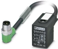
Cavo sensore/attuatore, 3-poli, PUR senza alogenati, grigio-nero RAL 7021, Maschio angolato M12 SPEEDCON, codifica: A, con 1 LED , su Connettore per valvole BI (11 mm), con 1 LED , Circuito: Diodo Z, lunghezza cavo: 0,6 m
