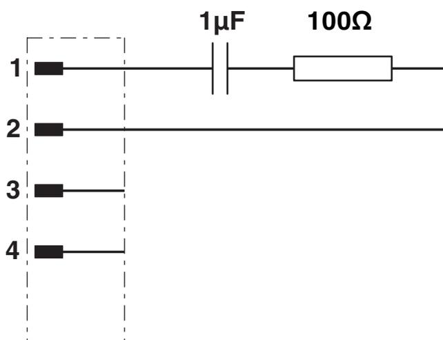
Equipaggiamento dei contatti e collegamento della resistenza terminale M12 FFB
