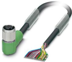
Cavo sensore/attuatore, 17-poli, PUR senza alogenati, nero RAL 9005, estremità conduttore libera, su Connettore femmina angolato M12 SPEEDCON, codifica: A, lunghezza cavo: 5 m
