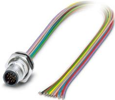
Connettore per apparecchi posteriore, Universale, 12-poli, Connettore, diritto, M12-SPEEDCON, codifica: A, su estremità conduttore libera, Montaggio posteriore, Pg9, Fili singoli, lunghezza cavo: 0,5 m, 0,14 mm<sup>2</sup>, Filo in TPE, saldato, Prodotto alternativo secondo RoHS II senza eccezione 6c (Pb < 0,1 %) cod. art.: 1239600
