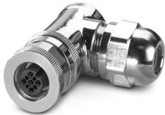
Connettore, Universale, 5-poli, schermata, Femmina angolato M12, codifica: A, Connessione a vite, materiale zigrinato: Ottone, nichelato, connessione a vite per cavo Pg9, diametro esterno conduttore 6 mm ... 8 mm
