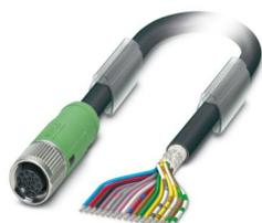
Cavo sensore/attuatore, 17-poli, PUR/PVC, nero RAL 9005, schermata, estremità conduttore libera, su Connettore femmina diritto M12 SPEEDCON, codifica: A, lunghezza cavo: 5 m
