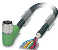
Cavo sensore/attuatore, 12-poli, PUR/PVC, nero RAL 9005, schermata, estremità conduttore libera, su Connettore femmina angolato M12 SPEEDCON, codifica: A, lunghezza cavo: 1,5 m
