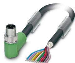
Cavo sensore/attuatore, 12-poli, PUR/PVC, nero RAL 9005, schermata, Maschio angolato M12 SPEEDCON, codifica: A, su estremità conduttore libera, lunghezza cavo: 5 m
