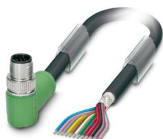
Cavo sensore/attuatore, 12-poli, PUR/PVC, nero RAL 9005, schermata, Maschio angolato M12 SPEEDCON, codifica: A, su estremità conduttore libera, lunghezza cavo: 1,5 m
