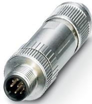
Connettore dati, VARAN, 6-poli, schermata, Maschio diritto M12, codifica: A, Connessione a perforazione di isolante, materiale zigrinato: Ottone, nichelato, diametro esterno conduttore 4 mm ... 8 mm
