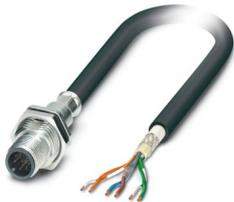
Connettore per apparecchi posteriore, 8-poli, SANTOPRENE privo di alogenati, nero RAL 9005, schermata, Connettore, diritto, M12, codifica: A, su estremità conduttore libera, Montaggio posteriore, M16 x 1,5, Collegamento del cavo, lunghezza cavo: 5 m, 0,25 mm<sup>2</sup>, Questo articolo è in continuo adattamento. Alternativa senza piombo secondo RoHS II senza eccezione 6c (Pb < 0,1%) possibile in anticipo su richiesta.
