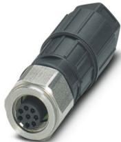
Connettore, Universale, 8-poli, Femmina diritto M12, codifica: A, Connessione a perforazione di isolante, materiale zigrinato: Acciaio legato 1.4404, diametro esterno conduttore 3 mm ... 7 mm
