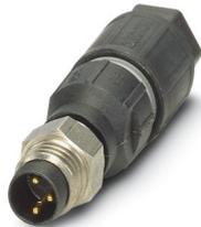
Connettore, 3-poli, Maschio diritto M8, codifica: A, Connessione a perforazione di isolante, materiale zigrinato: Acciaio inox 1.4305, diametro esterno conduttore 2,5 mm ... 5 mm
