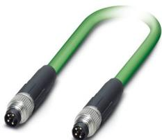
Cavo di rete, Ethernet (100 MBit/s), PROFINET (100 MBit/s), EtherCAT® (100 MBit/s), 4-pol., PUR senza alogenati, verde RAL 6018, schermata, Maschio diritto M8, codifica: A / IP67, su Maschio diritto M8, codifica: A / IP67, lunghezza cavo: 3 m
