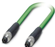
Cavo di rete, Ethernet (100 MBit/s), PROFINET (100 MBit/s), EtherCAT® (100 MBit/s), 4-pol., PUR senza alogenati, verde RAL 6018, schermata, Maschio diritto M8, codifica: A / IP67, su Maschio diritto M8, codifica: A / IP67, lunghezza cavo: 0,2 m
