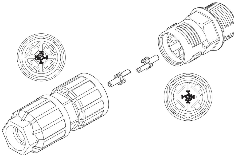
Codifica della connessione QUICKON
