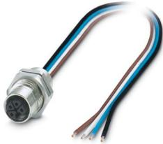
Connettore per apparecchi posteriore, Potenza, 4-poli, Femmina, diritto, M12-Standard, codifica: L, su estremità conduttore libera, Montaggio posteriore, M16 x 1,5, Fili singoli, lunghezza cavo: 0,2 m, 1,31 mm<sup>2</sup>, Filo per l'elettronica UL/cUL, saldato, Prodotto alternativo secondo RoHS II senza eccezione 6c (Pb < 0,1 %) cod. art.: 1239548
