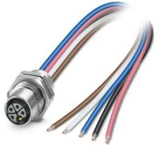
Connettore per apparecchi posteriore, Potenza, 5-poli, Femmina, diritto, M12-Standard, codifica: L, su estremità conduttore libera, Montaggio posteriore, M16 x 1,5, Fili singoli, lunghezza cavo: 0,2 m, 1,31 mm<sup>2</sup>, Filo per l'elettronica UL/cUL, saldato, Prodotto alternativo secondo RoHS II senza eccezione 6c (Pb < 0,1 %) cod. art.: 1239544
