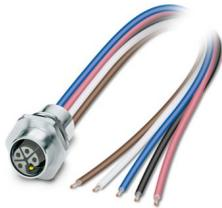
Connettore per apparecchi anteriore, Potenza, 5-poli, Femmina, diritto, M12-Standard, codifica: L, su estremità conduttore libera, Montaggio anteriore, M16 x 1,5, Fili singoli, lunghezza cavo: 0,2 m, 2,50 mm<sup>2</sup>, Filo in PEX, saldato, Prodotto alternativo secondo RoHS II senza eccezione 6c (Pb < 0,1 %) cod. art.: 1239514
