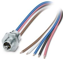
Connettore per apparecchi anteriore, Potenza, 5-poli, Connettore, diritto, M12-Standard, codifica: L, su estremità conduttore libera, Montaggio anteriore, M16 x 1,5, Fili singoli, lunghezza cavo: 0,2 m, 2,50 mm<sup>2</sup>, Filo in PEX, saldato, Prodotto alternativo secondo RoHS II senza eccezione 6c (Pb < 0,1 %) cod. art.: 1239513
