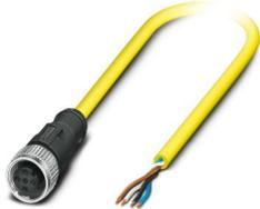
Cavo sensore/attuatore, 4-poli, PVC, giallo, estremità conduttore libera, su Connettore femmina diritto M12, codifica: A, lunghezza cavo: 15 m
