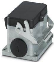
Custodia a zoccolo B48, con blocc. longitudinale, materiale: Pressofuso di alluminio, impermeabile, materiale coperchio: PA, uscite cavi: 2, laterali, 2x Pg36, altezza: 99 mm, connessione a vite per cavo: senza, coperchio di protezione: sì, Standard
