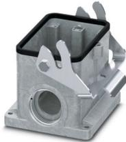
Custodia a zoccolo B48, con blocc. longitudinale, materiale: Pressofuso di alluminio, impermeabile, uscite cavi: 2, laterali, 2x Pg36, altezza: 99 mm, connessione a vite per cavo: senza, Standard
