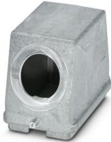
Custodia protettiva B48, per bloccaggio longitudinale, materiale: Pressofuso di alluminio, impermeabile, uscite cavi: 1, laterali, 1x M50, altezza: 107,5 mm, connessione a vite per cavo: senza, Standard
